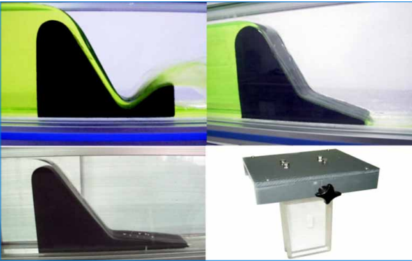
CFGVVP. Presas vertedero y pilares (3 modelos diferentes de presas)
