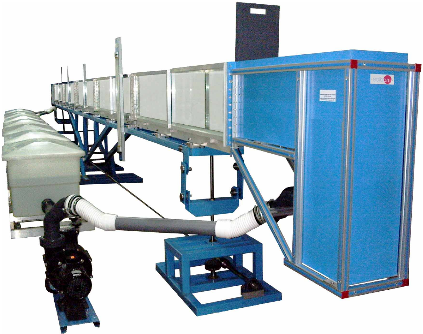
CFG. Canales de Fluidos (sección:300 x 450 mm)
