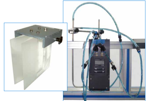
CFGTVC. Tubo venturi con transductores de presión, convertidor e indicador digital de presión diferencial para la medida de caudal de entrada
