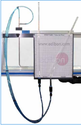
CFGTR. Tubo de Pitot con panel de manómetro
