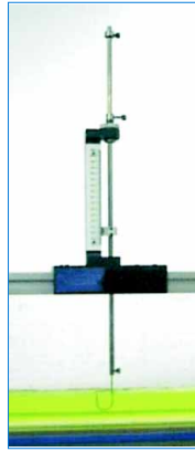
CFGRM. Regleta de medición de la altura del agua (limnómetro)
