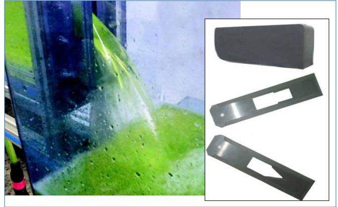
CFGVDG. Vertederos de pared delgada y gruesa
