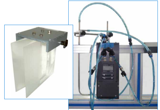
CFTVC. Tubo venturi con transductores de presión, convertidor e indicador digital de presión diferencial para la medida de caudal de entrada
